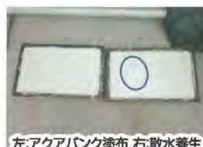
左:アクアバンク塗布 右:散水養生
