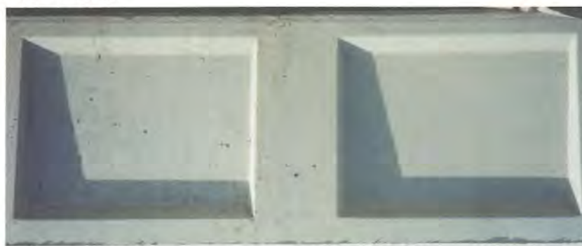
一般的剥離剤使用
